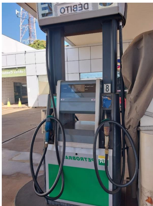
FOTO 48: Bomba de combustível Wayne dupla.
