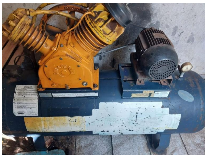
FOTO 44: Compressor Chiaperoni 5HP 250 pés.
