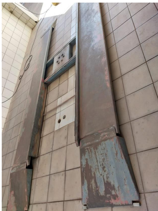
FOTO 46: Elevador pneumático com prancha quatro toneladas.
